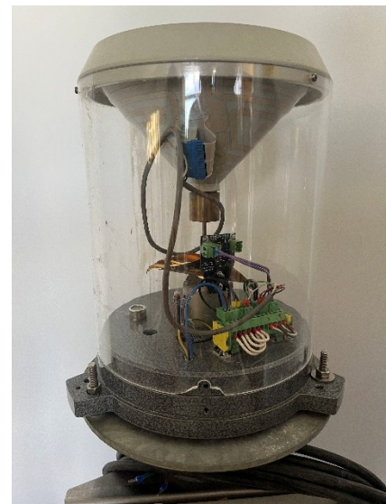
Figur 1: Demomodel af SVKs regnmåler, hvor man bl.a. kan se vippeskeen.
